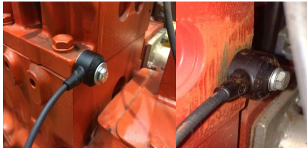
6. ábra: A gyorsulásmérő szenzor rögzítése az első rögzítési helyen (bal) és a második rögzítési helyen (jobb)
