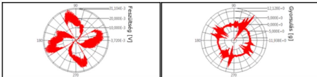
11. ábra: Gyújtótranszformátor működése és keresztirányú rezgések együttes megjelenítése
